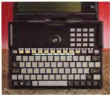
La tastiera (su versione inglese) è completa e consente un facile modo preciso, intuitivo e veloce di operare. Sotto il display di servizio c'è il pulsante di accensione. Il display vero a ampio di qualità elevata presenta uno schermo ridotto.
